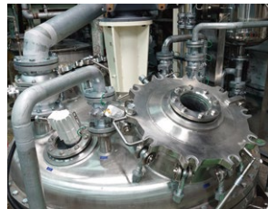
【5000L攪拌設備】 接着剤を製造する釜です。
