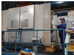
【複合ターニング機】 多面形状部品の加工が可能な機能集約立形複合加工機
